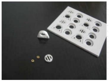
Die aus eine Platte gefrästen Teile
