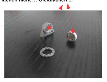
Drehkranz jeweils nur von einer Seite zu 4/5 mittig durchbohren, mit 1mm Rundstäben je eine 3mm-Seilscheibe einsetzen
