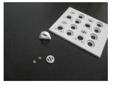
Einzelteile Rollendrehklüse *Heighton* aus Platte gefräst Gehäuse , Drehkranz, Abdeckung 2x Seilrollen Zukaufteil
